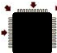
QFP他のICは4辺すべてのピンを検査するため、テーブルまたはカメラの回転による全方位検査が不可欠な機能となります。
