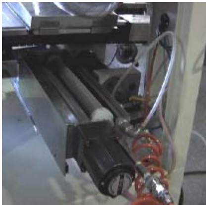
スプレーフラクサー（ドラムメッシュ）ユニット （C250ではオプションとして供給）
