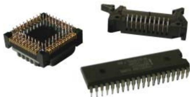
上部ヒーターの熱で損傷が懸念される部品(右上のコネクタ)に対しては加熱時間を多少延長し下部ヒーターのみで除去します。
