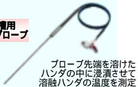
プローブ先端を溶けたハンダの中に浸漬させて溶融ハンダの温度を測定
