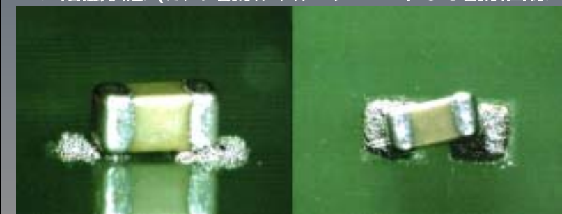
↓ 溶融状態 (カメラ観察システムVDM-3による観察画像)
