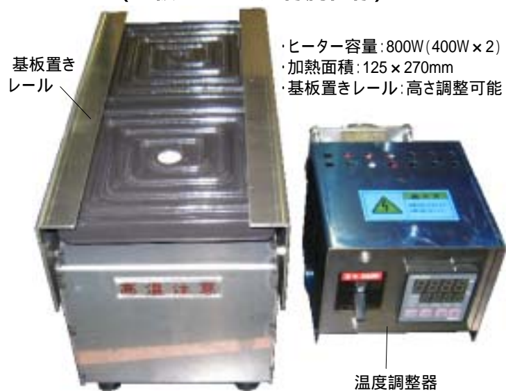
製作例-1・プレートヒーター・2枚タイプ (基板置きレール付属仕様)
