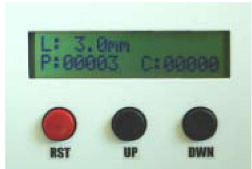
■リード長を0.1mm単位で設定できる液晶画面
