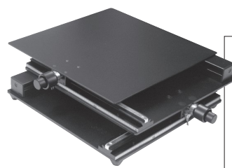
SFC 傾斜ステージXY \theta (台座付) 1回転4ミリ、ネジ送り式 XY : \pm 25 ミリ \theta : 360^\circ 傾斜: \pm 6^\circ 耐荷重: 4kg
