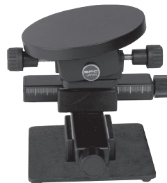
SFC 傾斜ステージXY \theta (台座付) 1回転4ミリ、ネジ送り式 XY : \pm 25 ミリ \theta : 360^\circ 傾斜: \pm 6^\circ 耐荷重: 4kg
