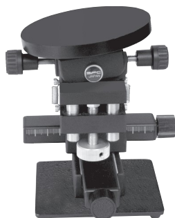
SFC 傾斜ステージXYZ \theta (台座付) 1回転4ミリ、ネジ送り式 XY : \pm 25 ミリ \theta : 360^\circ Z : \pm 3 ミリ 傾斜: \pm 6^\circ 耐荷重: 4kg
