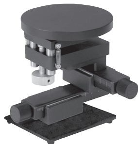
SFC XYZ \theta ステージ(台座付) 1回転4ミリ、ネジ送り式 XY : \pm 25 ミリ Z : \pm 3 ミリ \theta : 360^\circ 耐荷重: 4kg
