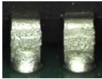
良好なフローアップ性 (DIP IC のリード部)
