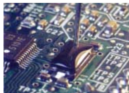
防湿コーティング剤の塗布作業
